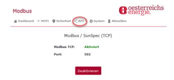
Die Kodierung der Register folgt dem Standard der SunSpec Alliance. Eine Spezifikation kann unter folgendem Link gefunden werden: https://sunspec.org/wp-content/uploads/2019/08/SunSpec-Specification-Meter-Models-A12023-1.2.pdf
